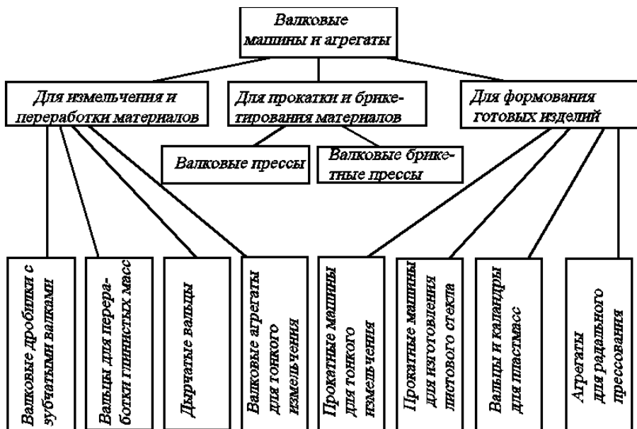
Рисунок 4.1. Классификация валковых машин и агрегатов
